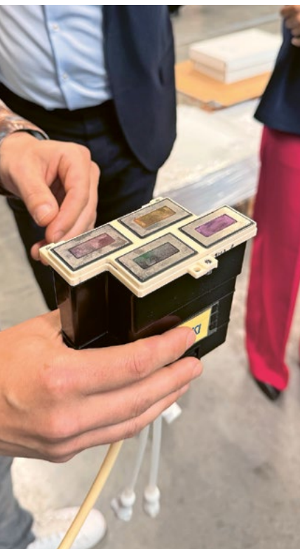
So sehen die Inkjet-Köpfe der varioPRESS iV7 aus. Es handelt sich dabei eine Eigenentwicklung.
